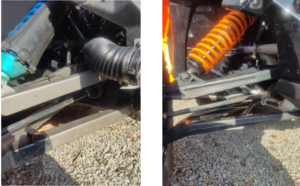
Figura 3: suspensão mais resistente (esquerda) e suspensão original (direita)
