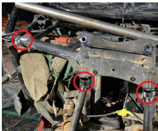
Figura 4: Pontos de falha do chassi
